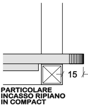
**REALIZZATO CON TUBOLARE DIM. 15x15 mm.**
